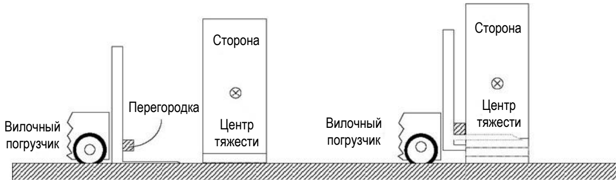
Рис. 4-6 Способ транспортировки вилочным погрузчиком
