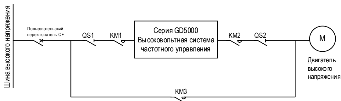
Рис. 7-6 Главная цепь шкафа автоматического байпаса
