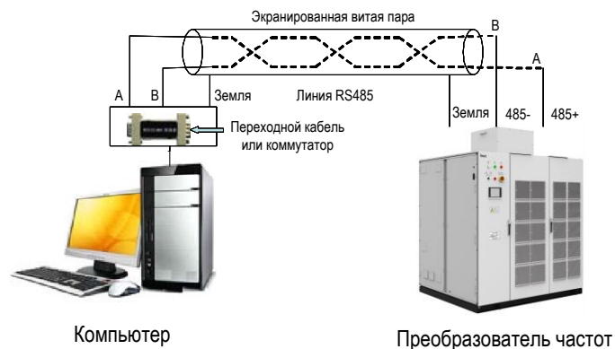
Рис. 10-1 Физическая проводка для автономного использования RS485
