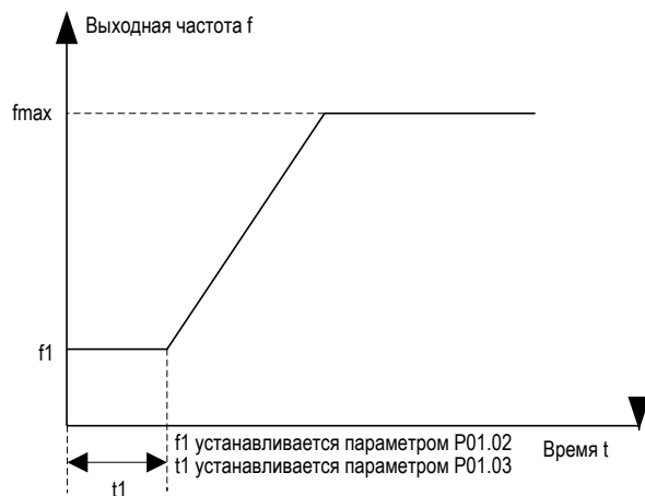
Рис. 6-3 Схема прямого запуска
